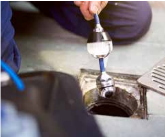
Telecamera per la videoispezioni negli scarichi fognari.
