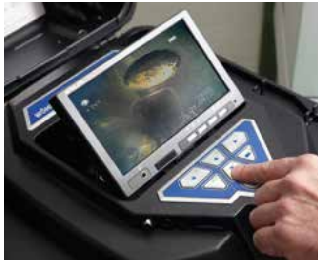
Videoispezione con registrazione foto e filmati, indicazione inclinazione, funzione home, metratura digitale, data e ora.
