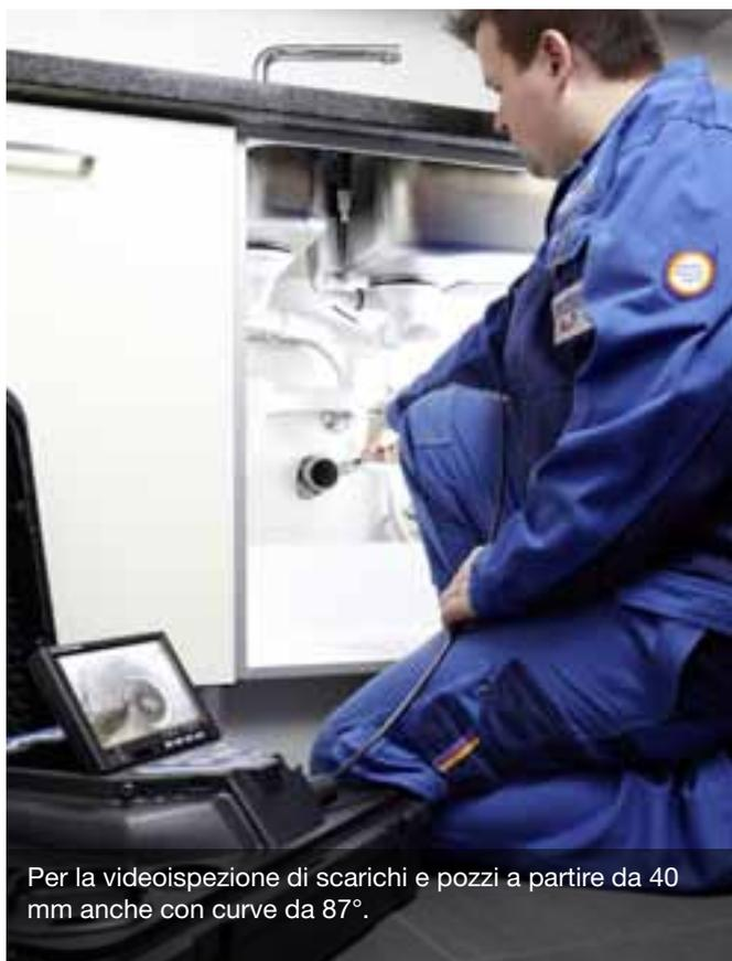
Per la videoispezione di scarichi e pozzi a partire da 40 mm anche con curve da 87°.
