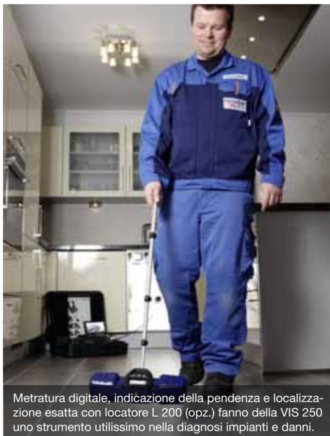
Metratura digitale, indicazione della pendenza e localizzazione esatta con locatore L 200 (opz.) fanno della VIS 250 uno strumento utilissimo nella diagnosi impianti e danni.
