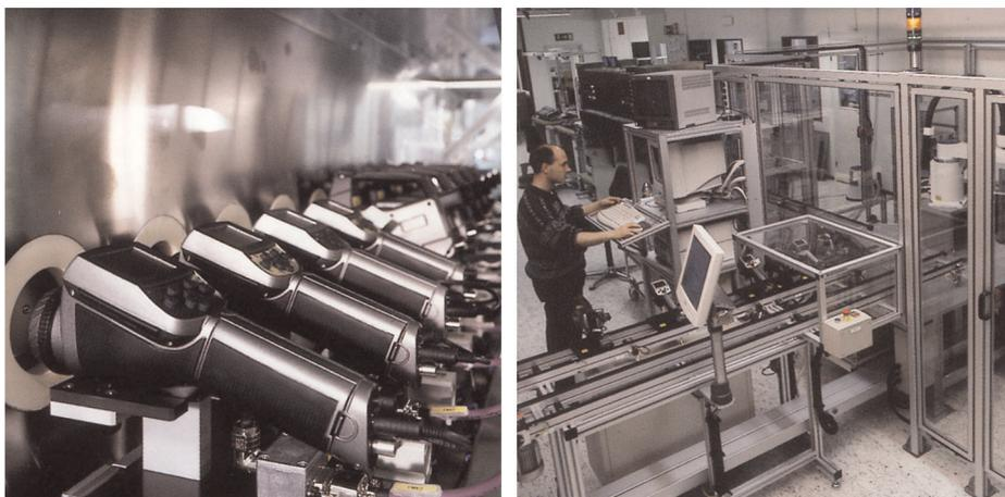
Figura 25.5 SINISTRA: collaudo delle termocamere ad infrarossi nella camera climatica; DESTRA: robot per il collaudo e la calibrazione delle termocamere
