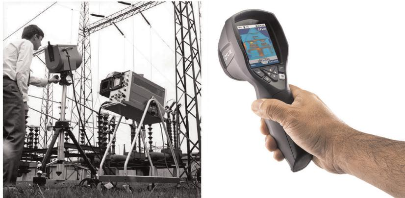
**Figura 25.2** SINISTRA: Thermovision Modello 661 del 1969. La termocamera pesava circa 25 kg, l'oscilloscopio 20 kg e lo stativo 15 kg. L'operatore inoltre doveva procurarsi un gruppo elettrogeno da 220 VCA ed un contenitore da 10 litri con azoto liquido. Alla sinistra dell'oscilloscopio è visibile l'attacco Polaroid (6 kg). DESTRA: FLIR i7 del 2012. Peso: 0,34 kg, batteria inclusa.
