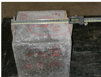
Foto n° 2 - Controllo dimensionale del provino
