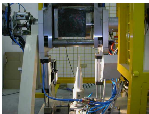
Foto n° 4 - Vista dell'ATHR (Alfa Test Hammer Robot) in azione
