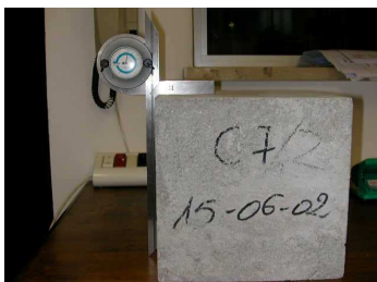
Foto n° 3 - Controllo della complanarità delle facce del provino
